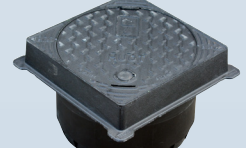
B : Tampon fonte B125 EN124 à verrou
