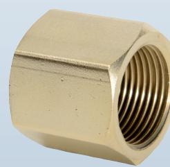
Pièce qui permet de raccorder deux pièces mâles égales ou inégales au pas du gaz y compris de type about fileté avec épaulement. L'étanchéité étant assurée par apport de matière comme ruban ou cordon en PTFE.
