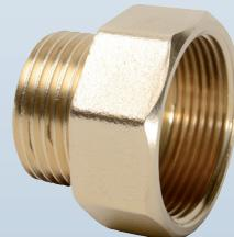
Réduction mâle /femelle à épaulement répondant au montage de deux pièces dont le filetage à un écart de 1 à 2 Ø nominaux. Fileté du 1/4" au 1"1/2 et taraudé du 3/8" au 2".
